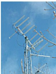
Le système d'antennes de la balise *moonbounce* de la SETI League. La station utilise quatre hélices 15 tours Olde Antenna Lab enroulées avec une polarisation circulaire droite (pour émettre), et quatre autres LHCP enroulées (pour recevoir les échos de la Lune). Les antennes peuvent être ajustées en azimut et en élévation grâce à un système de rotor Yaesu G5600B. Notez que les hélices sont réparties de chaque côté pour minimiser le moment de torsion sur le rotor d'élévation.
